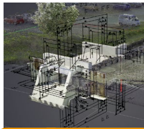
三面図 施工後点群を計測
